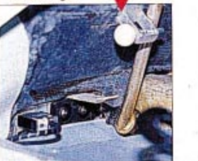
STECKKONTAKTE in der Wurzelrippe für Stromversorgung und Steuerleitungen.
