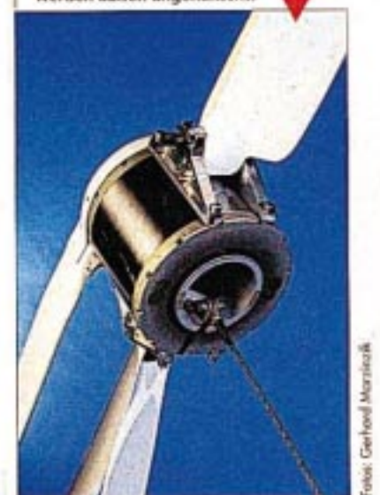
KOMPAKT: der 42 kW starke E-Motor. Die Popellierblätter werden außen angeflanscht.
