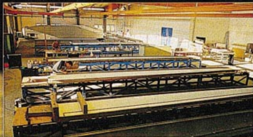
IN DER NEUEN Werkhalle von Lange Flugzeugbau entstehen gerade die Produktionsformen für den 20-m-Flügel der Antares.
