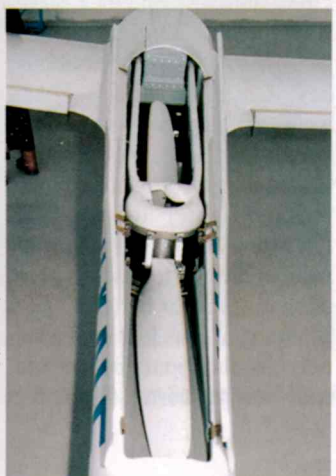
Ruhezeit: Der eingefahrene Antrieb, kurz bevor sich die Klappen schließen
