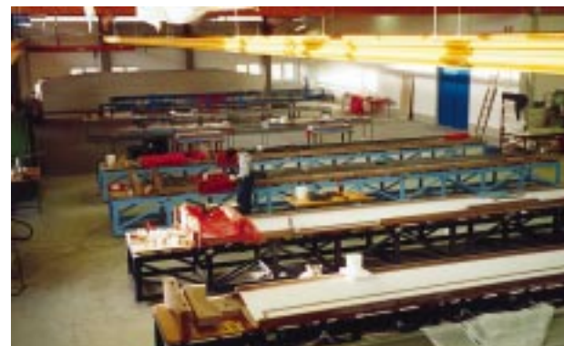
De 6 vleugelmallen van de Antares worden deels met de hand gemaakt
