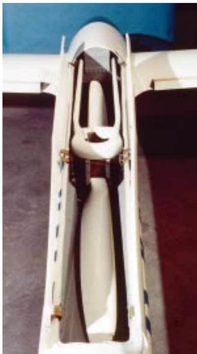
Ingeklapt past de propeller van 2 meter maar nauwelijks in de romp
