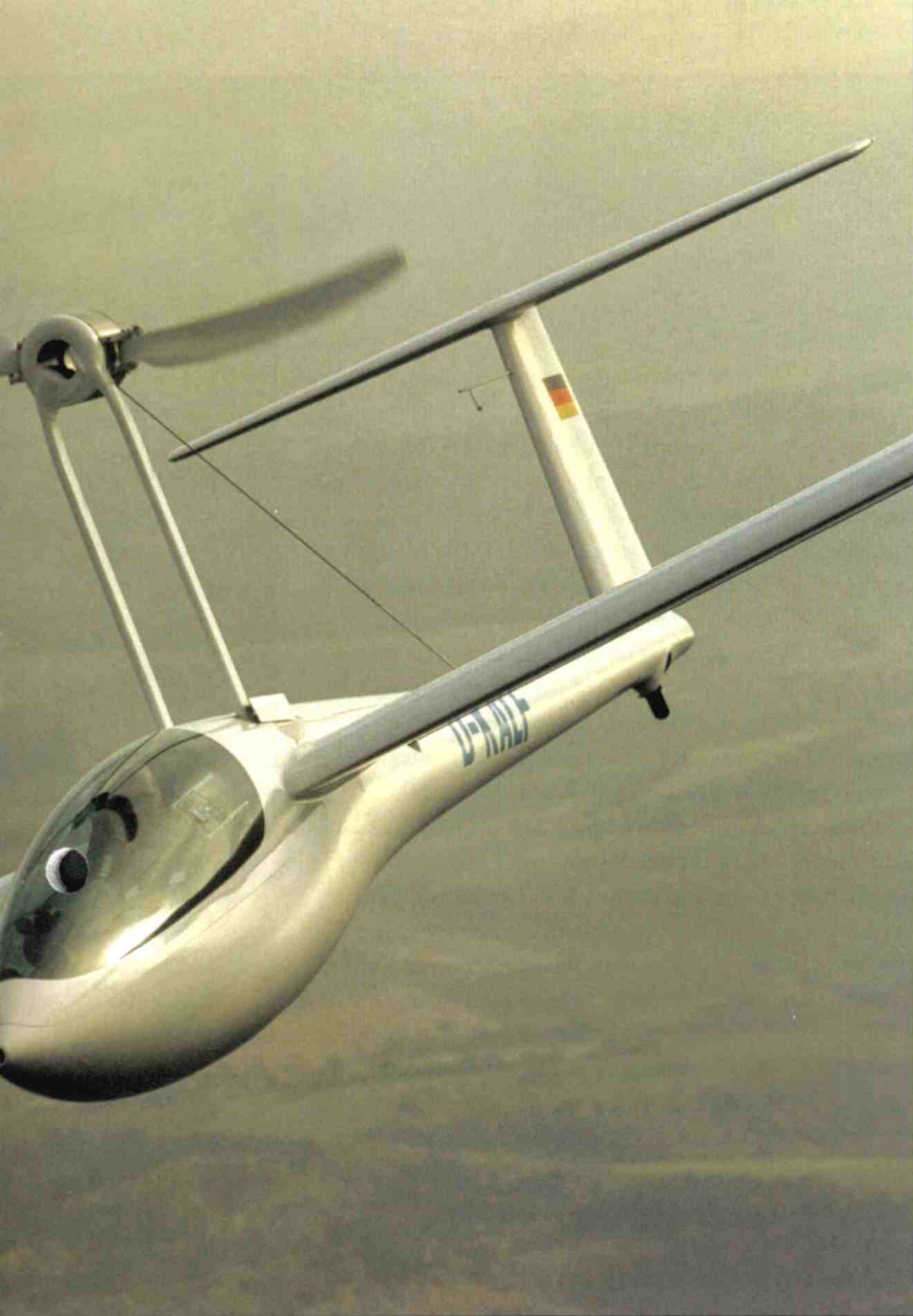
KLF-20E test-zweefvliegtuig van Lange Flugzeugbau met elektromotor.
